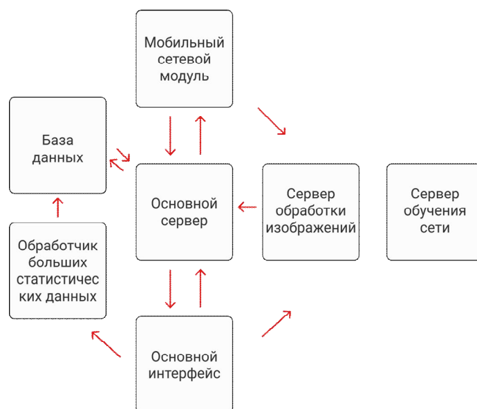
Рис. 1. Архитектура распределения вычислительных мощностей в зависимости от решаемых задач
